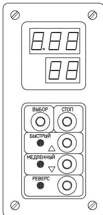
**Рисунок 1. Органы индикации и управления БПР-08Р**
